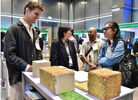
Sáng kiến tận dụng lõi ngô và giấy thải sản xuất thành vật liệu xây dựng. (Ảnh: Kiều Chi)
